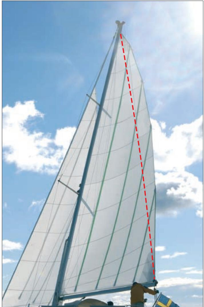
Wer meint, dass ein Rollsegel kein ausgestelltes Achterliek haben kann, ist nicht auf dem neuesten Stand. Die neuen Seldén-Rollmasten wurden für ein stark ausgestelltes Achterliek mit vertikalen Latten entwickelt.
