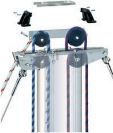
*Nehmen Sie die Instrumenten-Basis und den Fallscheiben-Separator ab. Wenn notwendig ersetzen Sie die Scheiben und setzen den Separator wieder ein.*
