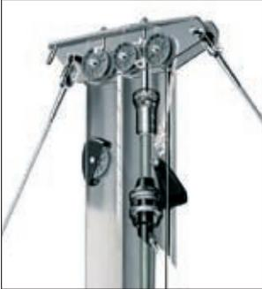
*Seldén-Rollmast: Getriebe mit Wansch für Endlosleine, gespanntes Rollprofil, asymmetrischer Segeleinlauf und der patentierte Lastverteiler im Fallschlitten. Das macht Aus- und Einrollen leicht und schnell.*
